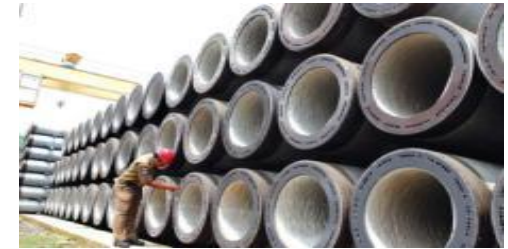
Tiang pancang bulat sentrifugal & segi empat sentrifugal ( spinning method ) dan tiang pancang segi empat & segitiga ( vibration method ).
